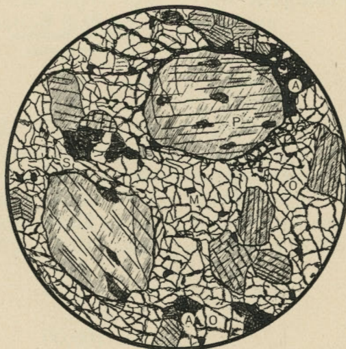
FIG. 4. — Péridotite à pyroxène. Coupe n o 21 B. Lumière naturelle. Grossissement = 43 diam. P = Pyroxène monoclinique. O = Olivine. A = Amphibole. M = Magnétite. S = Spinelle.
