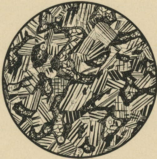
FIG. 6. — Troctolite. Coupe n° 29 B. Lumière naturelle, les plagioclases en lumière polarisée. Grossissement = 25 diam. H = Hypersthène. O = Olivine. A = Amphibole. S = Spinelle. F = Plagioclases.
