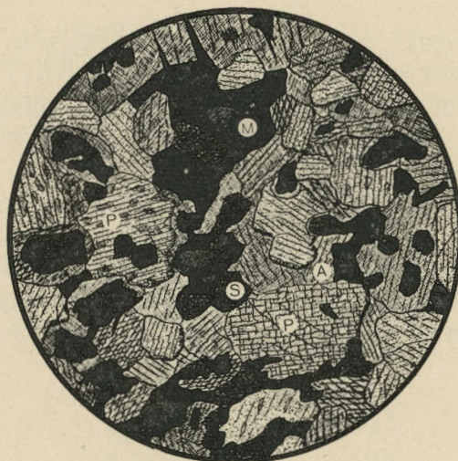
FIG. 5. — Ostraïte. Coupé n° 59 B. Lumière naturelle. Grossissement = 43 diam. P = Pyroxène monoclinique. A = Amphibole. M = Magnétite. S = Spinelle.
