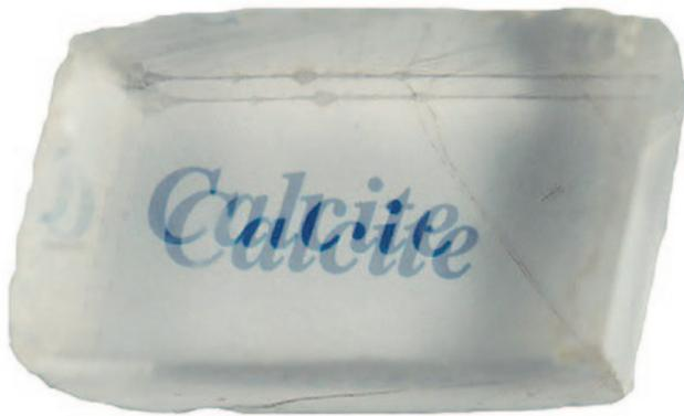
Abbildung 2: Dieser Calcithomboeder zeigt eindrücklich die Doppelbrechung: Die in den Kristall eintretende Lichtwelle wird in zwei Lichtwellen aufgespalten, die mit unterschiedlichen Geschwindigkeiten und Richtungen durch den Kristall reisen, daher unterschiedliche Brechungsindizes aufweisen und so den Schriftzug unter dem Kristall doppelt abbilden.
