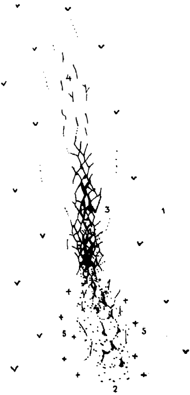
Рис. 74. Идеализированная схема строения системы хромитовых жил: 1 — протодуниты; 2 — хромитовая вкрапленность и хромитизированные дунитовые брекчии; 3 — цементные хромитовые жилы; 4 — тонкие линейные хромитовые жилки; 5 — постмагматически-перекристаллизованные дуниты
